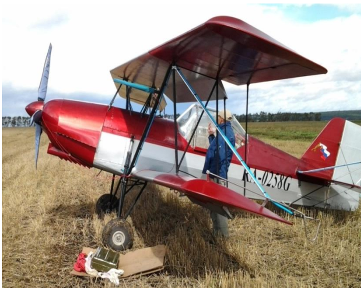
Самолет «Шмель» с двигателем Субару EJ-25
